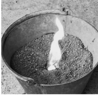
第13図 化学反応による鉄の生成
